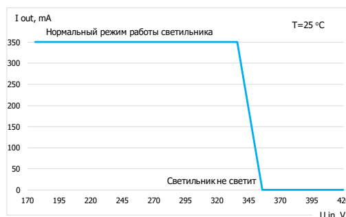
Рисунок 7 – Работа защиты от превышения входного напряжения при максимальной нагрузке и T_a=25 °C
